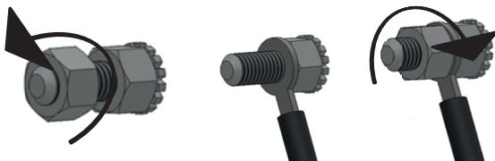
Rys. 4. Podłączenie urządzenia do instalacji wyrównującej potencjały elektryczne.
