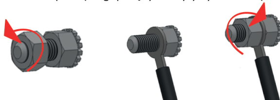
Rys. 4. Podłączenie urządzenia do instalacji wyrównującej potencjały elektryczne.
